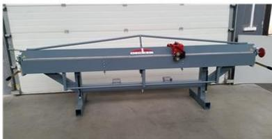
**Листогиб ручной усиленный Decker X7-3250/1** (Комплектация: станок, роликовый нож, угломер, задний стол, газовые компенсаторы 4 шт.)
